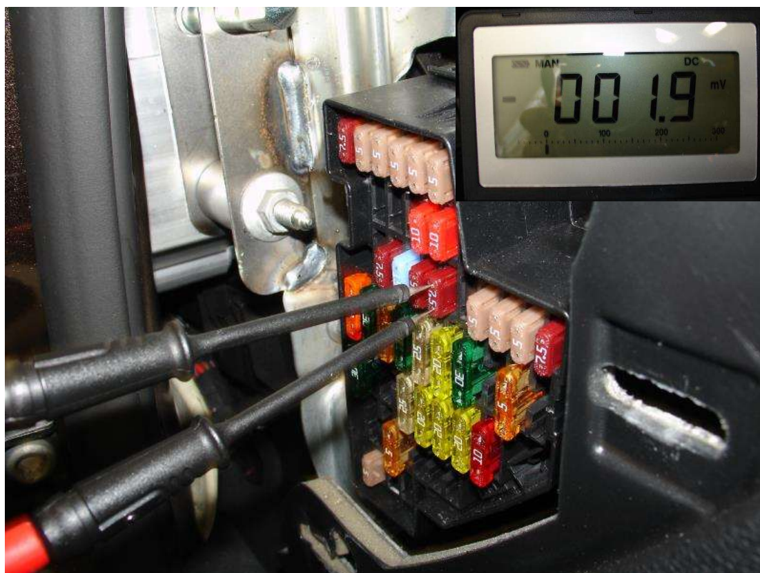
Илл. 1. Измерение тока на предохранителе
