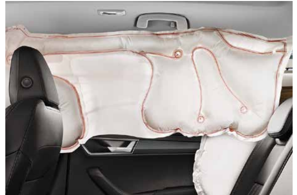
Работа шторок в сочетании с передними (верхнее фото) и задними боковыми подушками.
