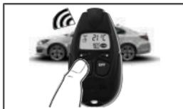
В зависимости от температуры в салоне автомобиля и выбранного уровня комфорта, Heating-Time-Management (НТМ, управление временем отопления) рассчитывает продолжительность отопления и время включения отопителя. Пользуйтесь приведёнными далее возможностями настройки.
